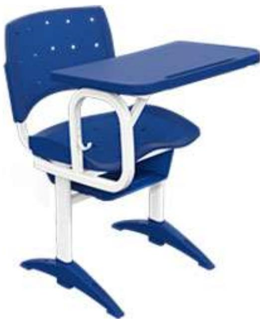
Esse por sua vez deve ser fabricado em um tubo 19mm de diâmetro e 1,06mm de espessura de parede reforçado internamente por um tubo de 16mm de diâmetro e 1,2mm de espessura de parede.
