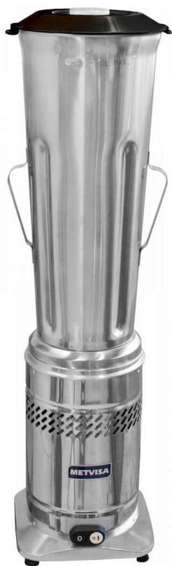
**LIQUIDIFICADOR INDUSTRIAL, COM CAPACIDADE DE 8 LITROS,** SISTEMA DE TRAÇÃO DE HÉLICE EM INOX, COM ENCAIXE, COPO EM AÇO INOX. TAMPA COM ENCAIXE JUSTO AO COPO, NÃO PERMITINDO VAZAMENTO DE LÍQUIDO DURANTE O PROCESSAMENTO. SAPATAS ANTIVIBRATÓRIAS EM MATERIAL ADERENTE, MOTOR DE 1/2 CV MONOFÁSICO, GABINETE EM AÇO INOX, VOLTAGEM: 220V; ROTAÇÃO MÍNIMA: 3500 RPM, POTÊNCIA MÍNIMA: 1000 W. **GARANTIA DE NO MÍNIMO 12 MESES CONTADOS A PARTIR DA DATA DE ENTREGA.**
